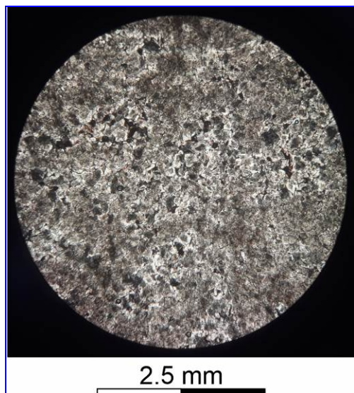
شکل ۳- نمایی از دولومیت‌های درشت بلور در مقطع نازک میکروسکوپی مربوط به نواحی دولومیتی شده در محدوده گسل‌ها برگرفته از ربانی و همکاران ۱۴۰۱
